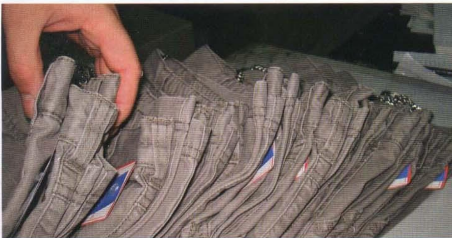
Die Ware kommt liegend im Logistikzentrum in Fritzlar an. Nach der Qualitätskontrolle werden die Teile gesannt und mit Hilfe von RFID eingelagert. Fotos: Checkpoint
